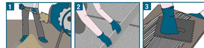
1 Préparer la mixture de sable et ciment dans la bétonnière, deux parties de ciment en poids avec chaque dix parties de sable. Le ciment et l'eau dans parties égales.
